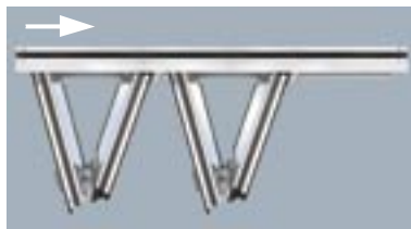
Schema 440* Rahmenaußenbreite bis 3600 mm*
